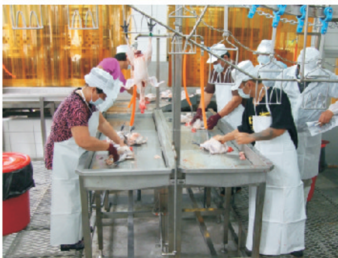
▲屠宰作業須在作業檯面一邊清洗一邊掏內臟後吊掛。
