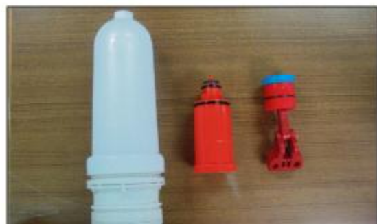
▲塑膠型人力噴霧器加壓器零件(如圖)組裝簡單，農友可自行利用簡易工具即可修護及保養。
